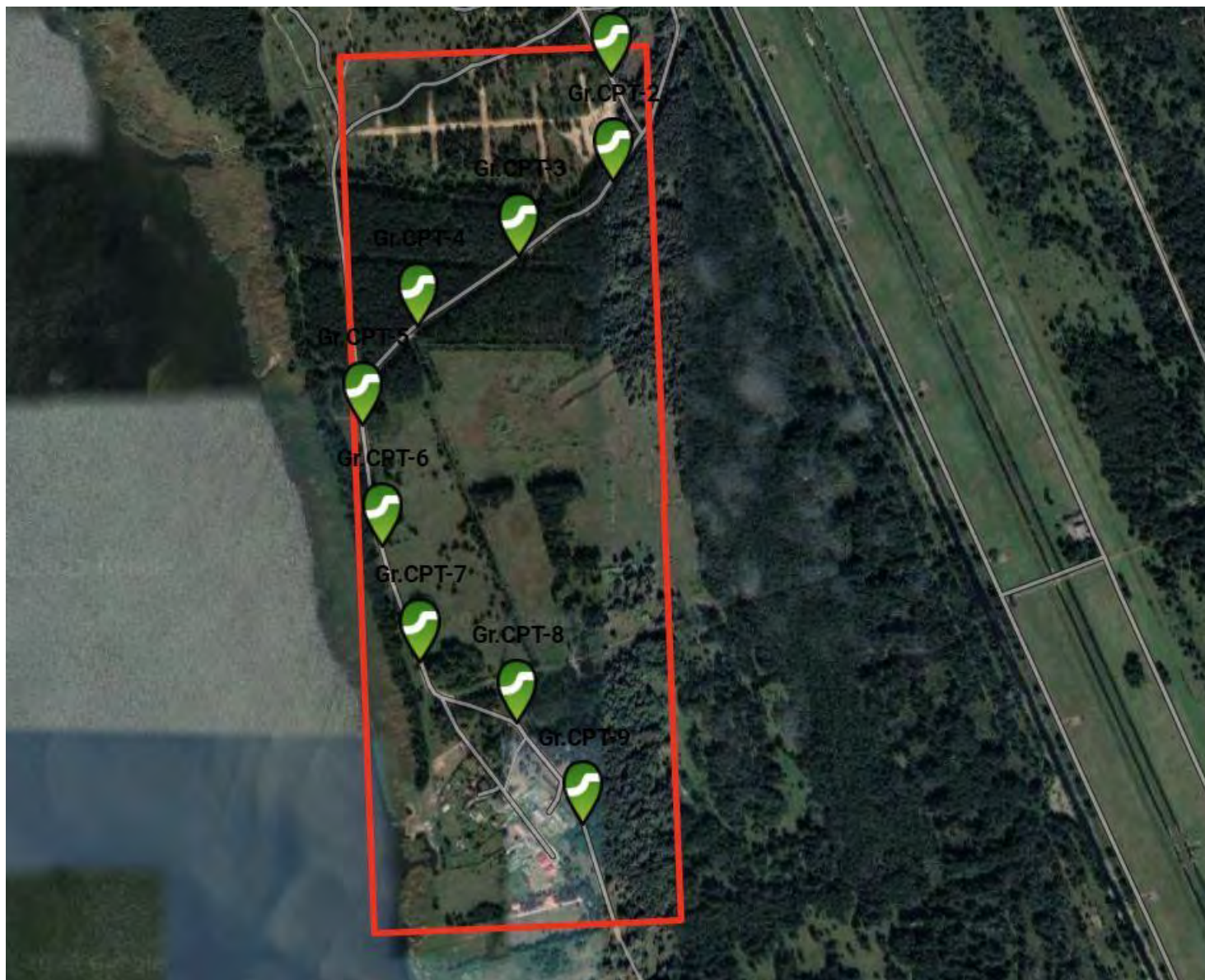
Priedas Nr. 4. Planas su lauko darbų tyrimų vietomis ir inžinerinių geologinių pjūvių linijomis
