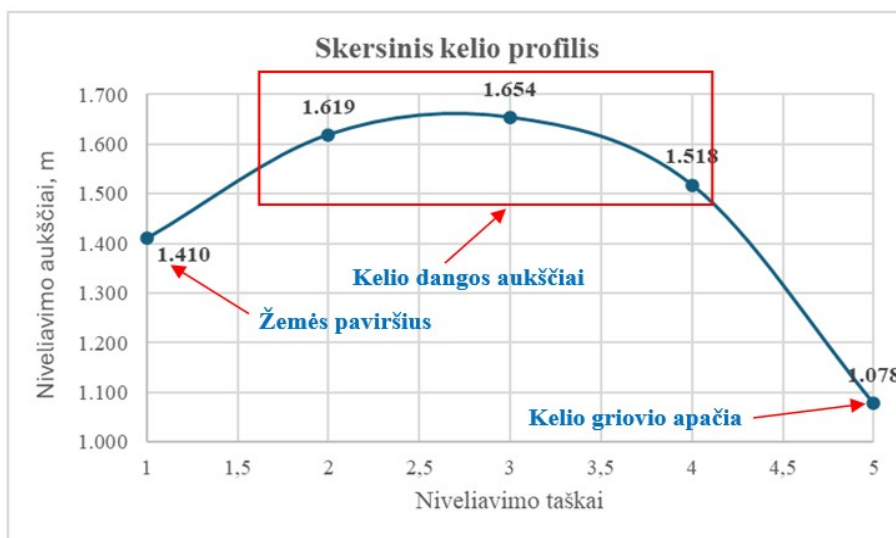
39 pav. Penktas kelio skersinis pjūvis
