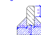
Vejos borto 100x20x8 įrengimo detalė M 1:20
