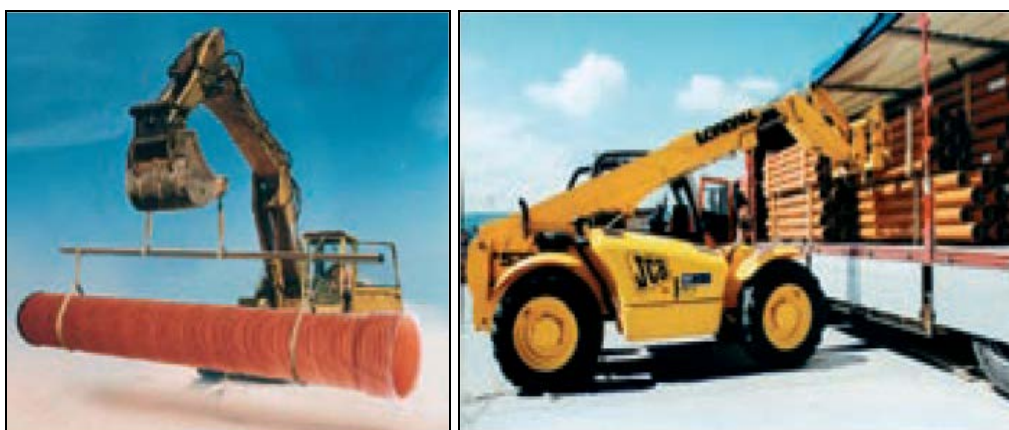
4 paveikslas. Mechanizuotas vamzdžių krovimas
