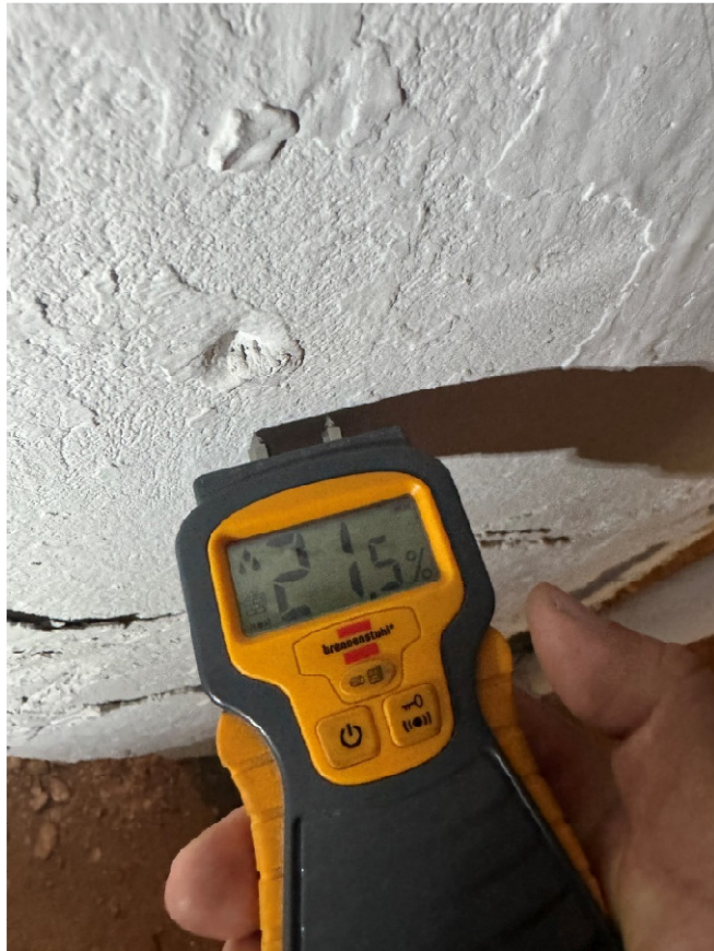
Pamatuota drėgmė pusrūsio sienose be apdailos (Patalpa P-48)
