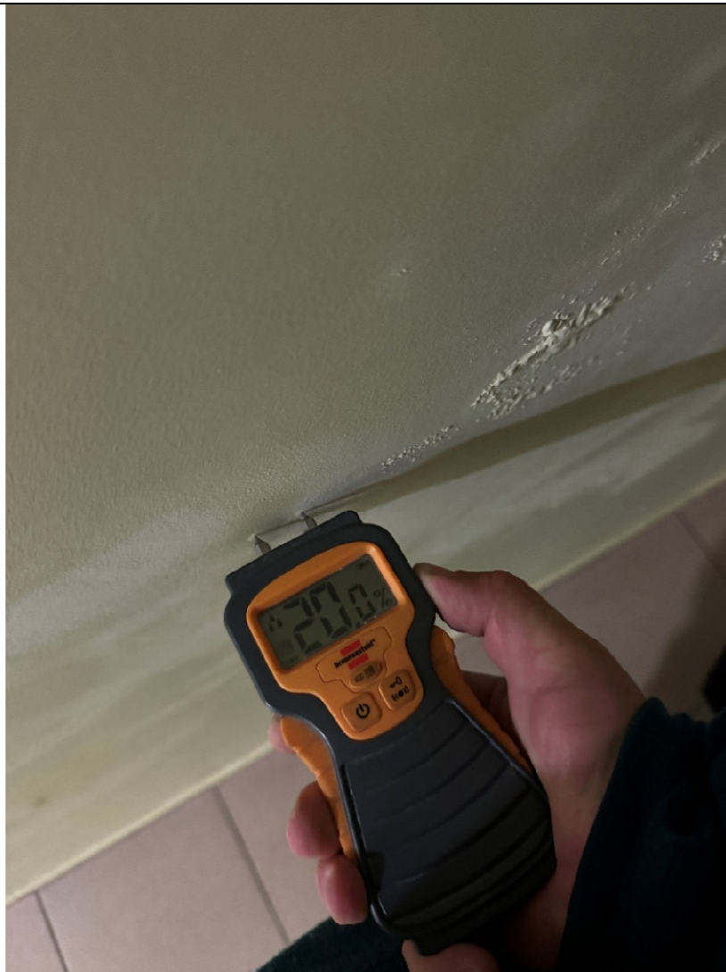
Pamatuota drėgmė pusrūsio sienose (Patalpa P-52)
