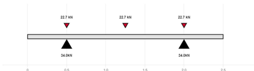
4. pav. Skersinės sijos laikančiosios galios skaičiavimai
