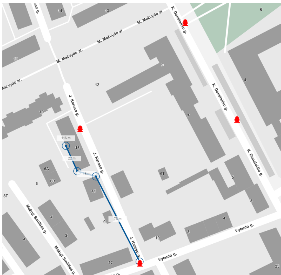
Pav. 3. Esami hidrantai aplink pastatą
