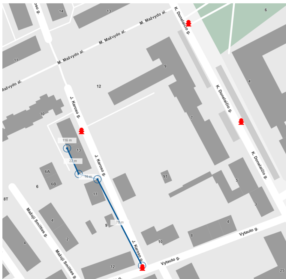
Pav. 2. Esami hidrantai aplink pastatą
