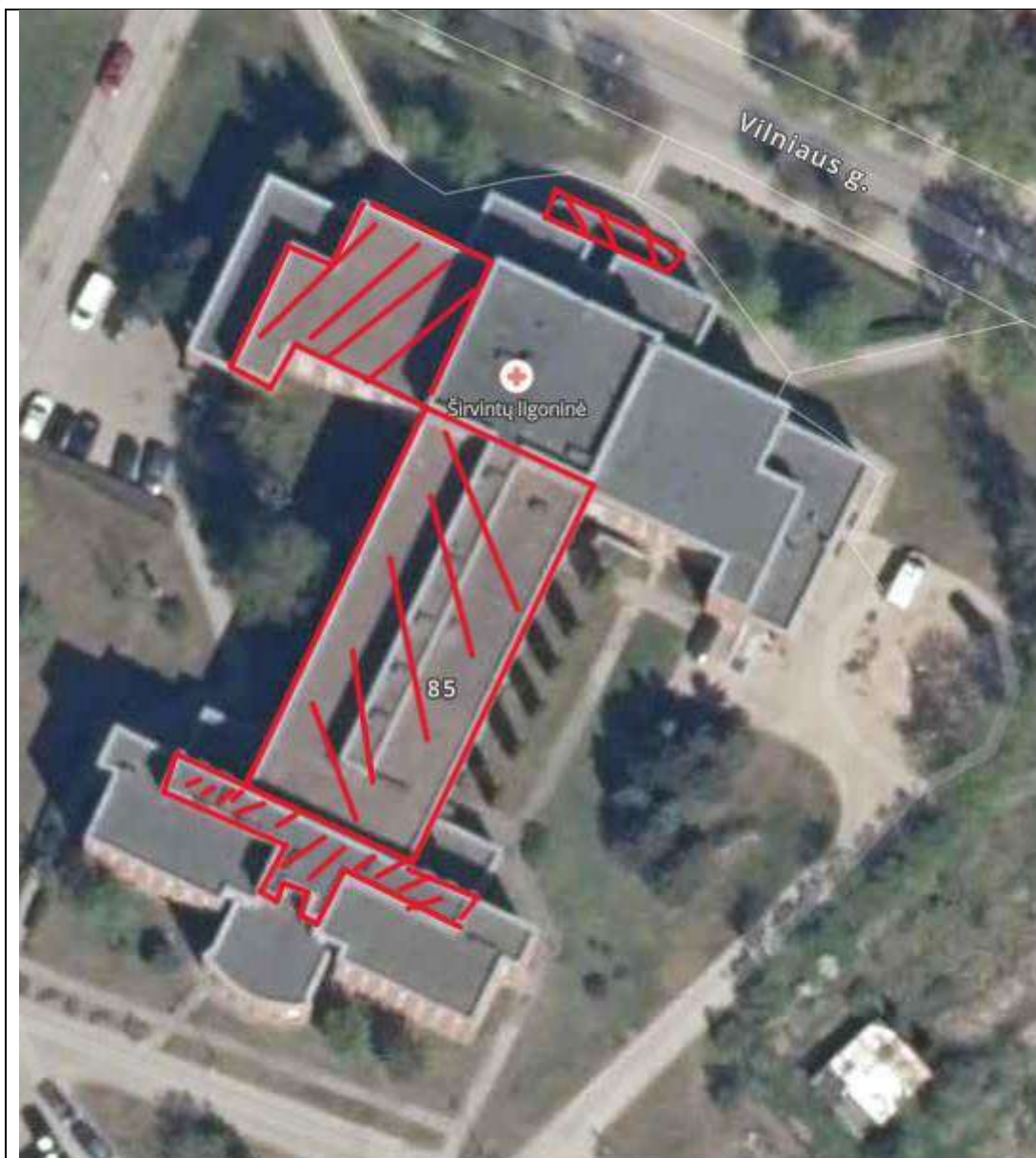
104. Nurodyti stogo plotai kuriuose ištaisai reikia pakeisti stogo dangą nauja.
