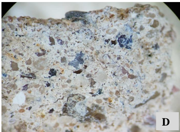
3 pav. Mėginys Nr.2 – T-2: A – mėginio paėmimo vieta; B – bendras mėginio vaizdas; C, D – mėginio vaizdas pro mikroskopą, x20; E – mėginio vaizdas pro mikroskopą, x40.
