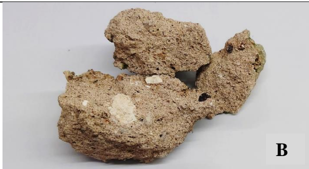
2 pav. Mėginys Nr.1 – T-1: A – mėginio paėmimo vieta; B – bendras mėginio vaizdas; C – mėginio skerspjūvio vaizdas pro mikroskopą, x20; D – mėginio vaizdas pro mikroskopą, x40; e – mėginio (karbonatinės kilmės intarpai) vaizdas pro mikroskopą, x20; F – mėginio (kalvės šlako intarpa) vaizdas pro mikroskopą, x40.
