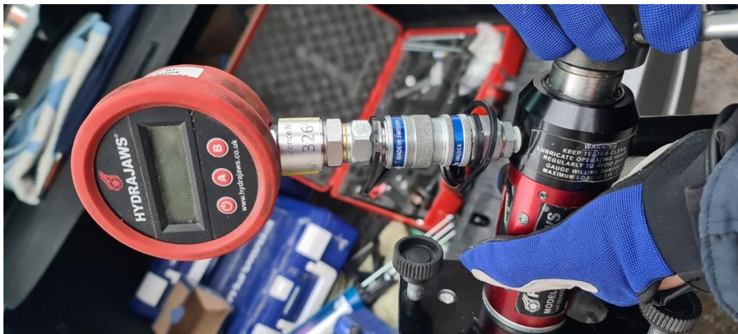
Nuotrauka Nr. 8 Tempimo testeris, modelis 2000, serijos Nr. MAN-3269, Kalibravimo liudijimas Nr. 112152-1-1
