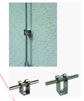
Jungtis d-8mm. su įžeminimo juosta 25x4mm. (ore)
