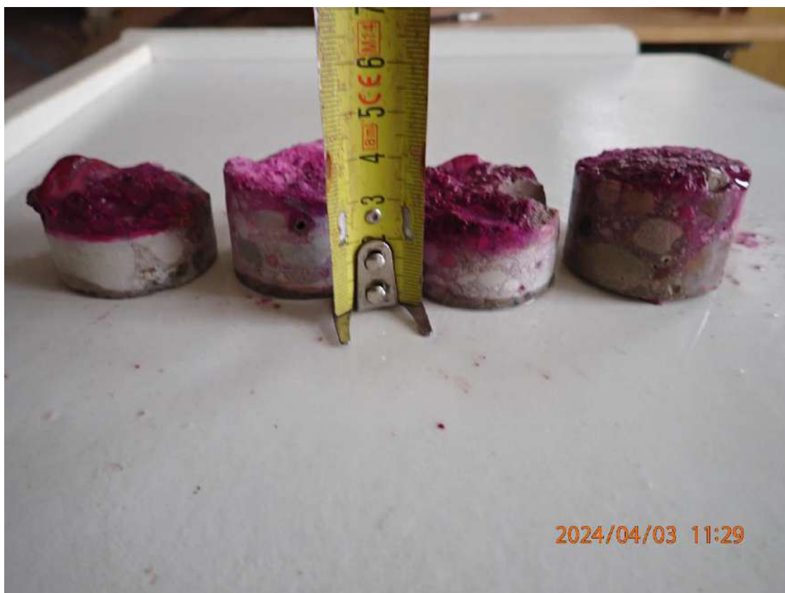
Nuotrauka Nr. 30. Perdangos plokštės betono kernų (ėminių) tyrimų rezultatai
