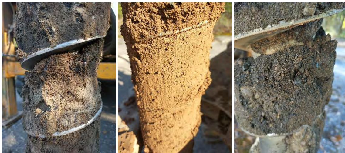
5 pav. Kairėje – piltinis gruntas šiaurinėje teritorijos dalyje (tIV), centre – moreninis priemolis (gIIIbl), dešinėje – piltinis gruntas rytinėje teritorijos dalyje, šalia buvusios katilinės (tIV).
