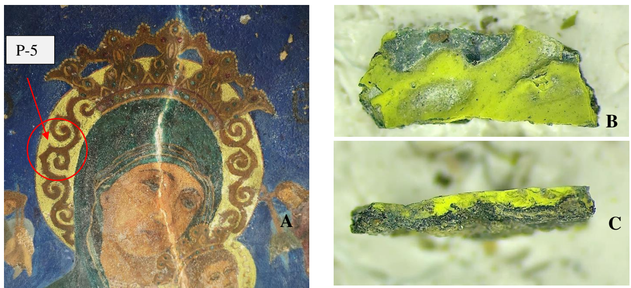
6 pav. Mėginys P-5: A – mėginio paėmimo vieta; B – mėginio vaizdas pro mikroskopą, x80; C – mėginio skerspjūvis pro mikroskopą, x100
