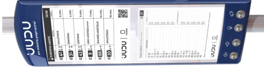
Pav. 5 Preliminarus E-Paper švieslentės dizaino modelis
