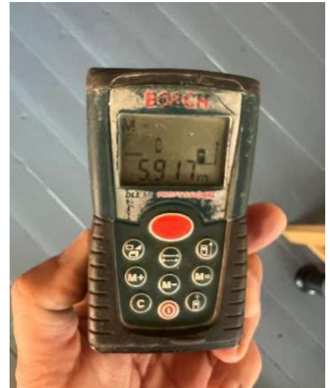
52 pav. Nustatytas plokštės ilgis „šviesoje“
