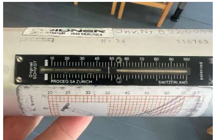
53 pav. Betono stiprio matavimas Šmidto plaktuku
