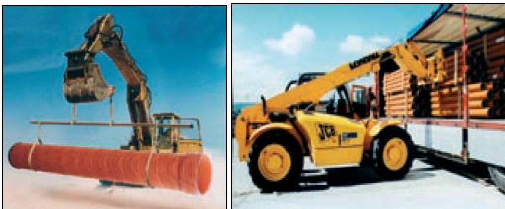
2 paveikslas. Mechanizuotas vamzdžių krovimas.
