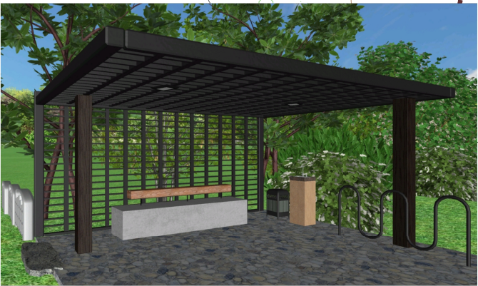
Pastogė dviračių įkrovos stotelėje Aukštis 2.5 m, ilgis 6 m, plotis 4 m
