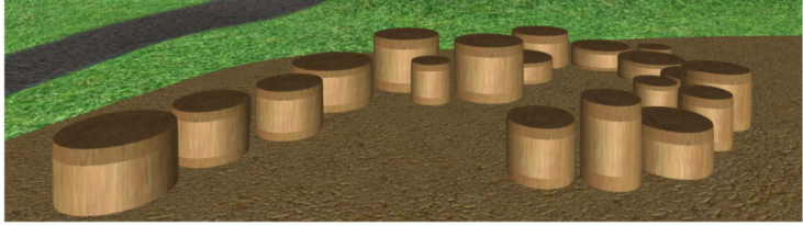
② Žingsniniai rąstai Bendras rąstų linijos ilgis: 10 m Rąstų skersmuo: 0.2 - 0.4 m Aukštis virš žemės: 0.1 - 0.2 - 0.3 - 0.4 - 0.5 m Rąstų požeminė dalis: 0.7 m Rąstai įtvirtinami betonuojant
