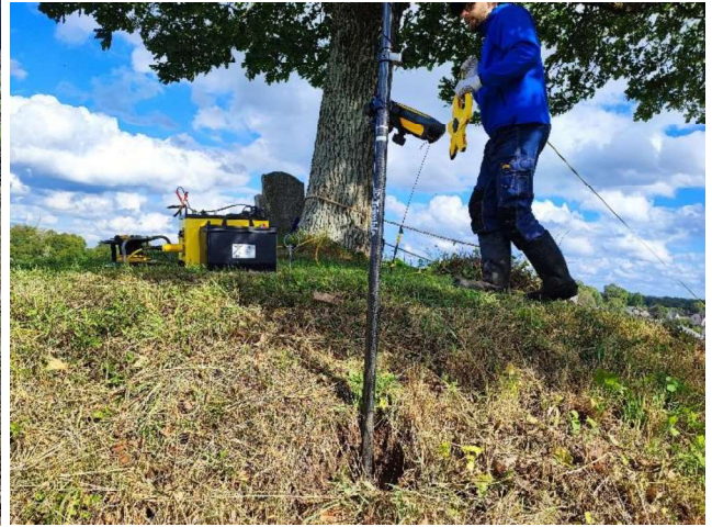
5, 6 nuotr. Piliakalnio kapinių teritorijoje šalia ištiesto ET profilio-2 atsekamas nuošliaužos atitrūkimo 22 m ilgio ir 2-3 – 5-8 cm pločio lineamentas (ET profilyje anomalinis 34-38 m intervalas, žr. 9 pav.).
