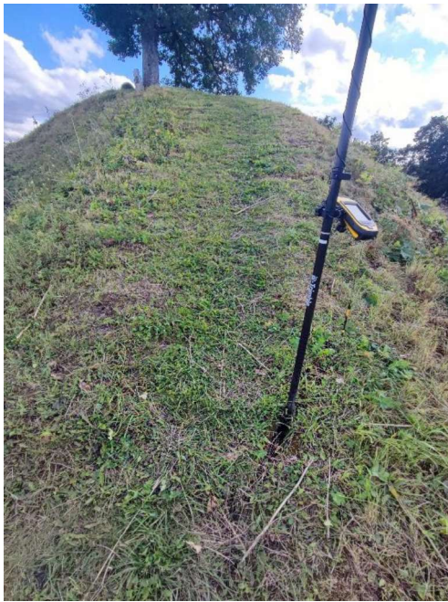
5, 6 nuotr. Piliakalnio kapinių teritorijoje šalia ištiesto ET profilio-2 atsekamas nuošliaužos atitrūkimo 22 m ilgio ir 2-3 – 5-8 cm pločio lineamentas (ET profilyje anomalinis 34-38 m intervalas, žr. 9 pav.).
