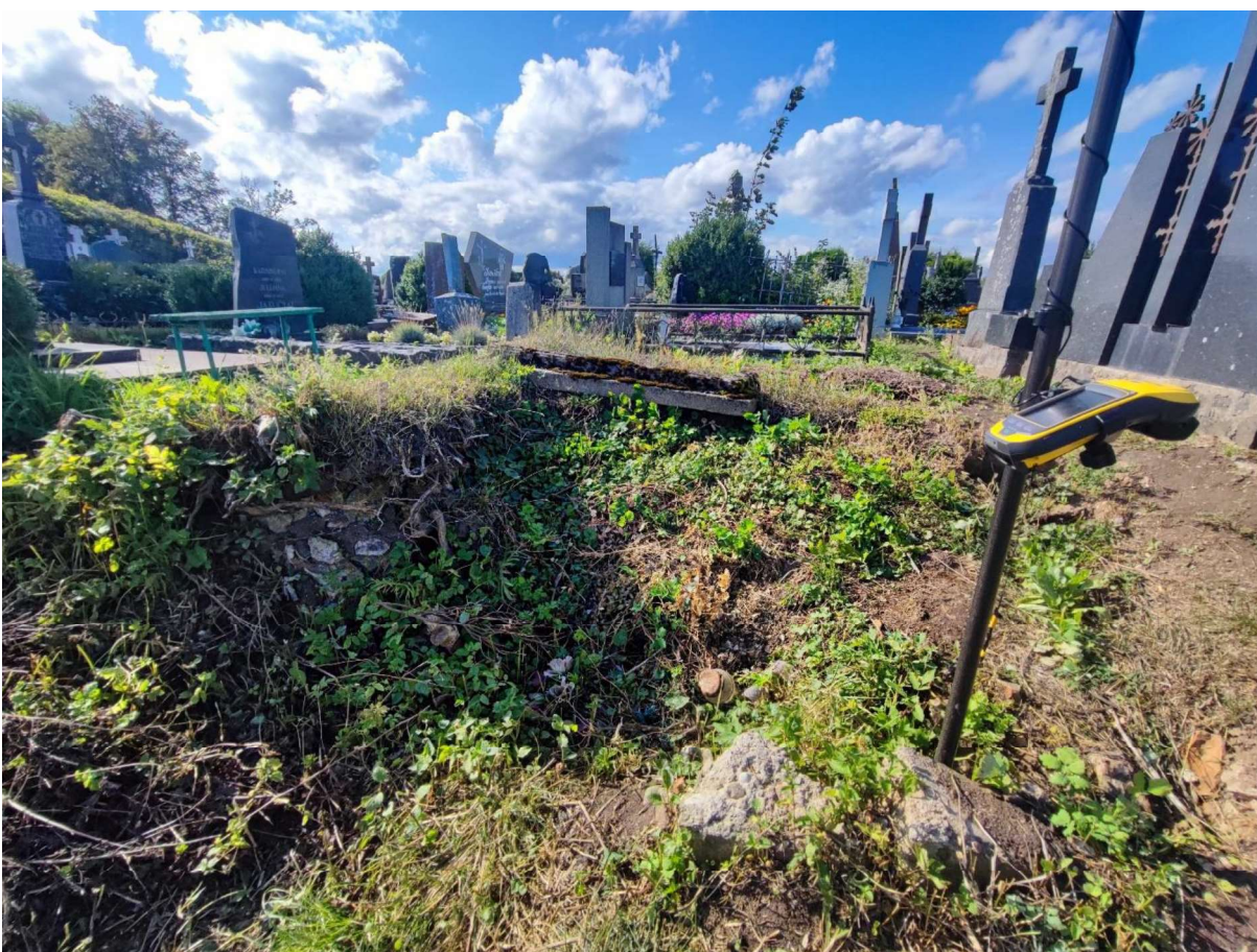
4 nuotr. 0,4-0,6 m gylio technogeninė duobė ir grunto suslūgimas Papilės I plkn. PR R šlaito viršutinėje dalyje (ET profilyje-1 pažymėta anomalija 63-72 m intervale, žr. 8 pav.)
