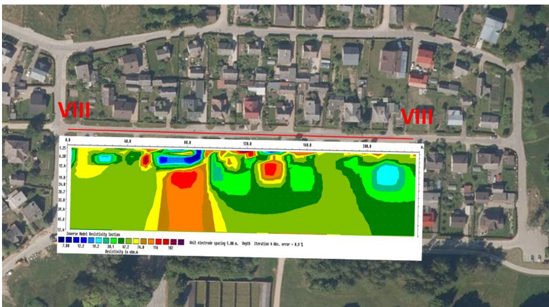
10 PAV. GEOELEKTRINIS PJŪVIS VIII-VIII
