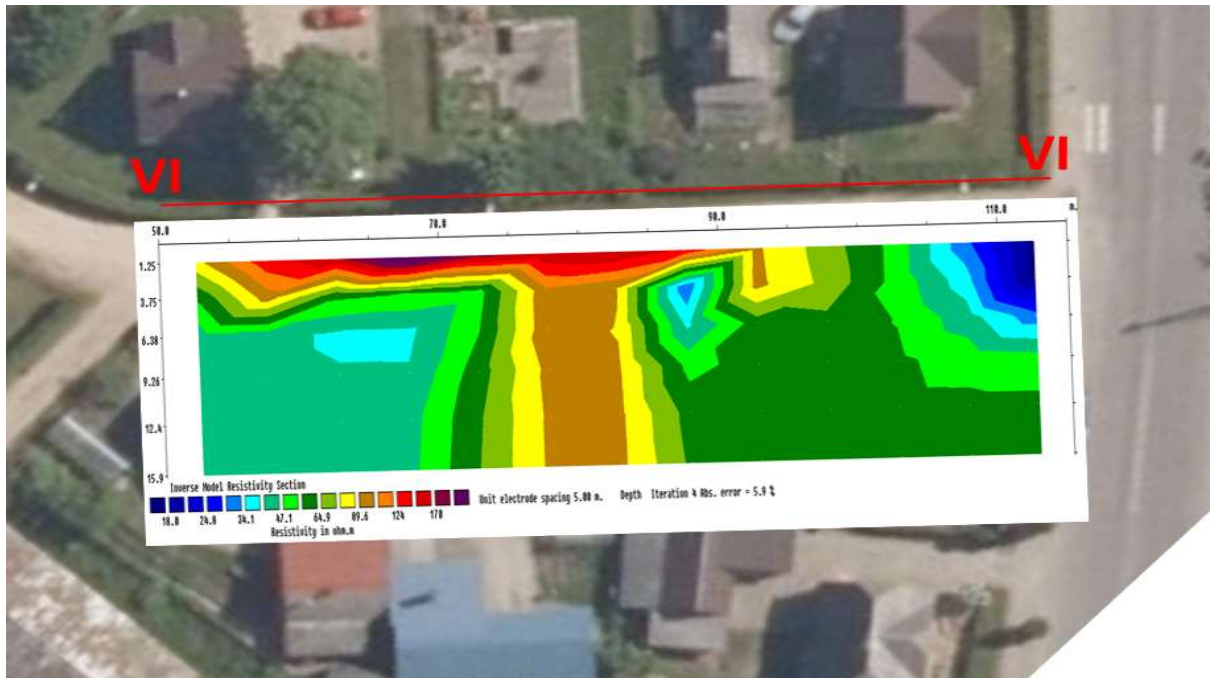
8 PAV. GEOELEKTRINIS PJŪVIS VI-VI
