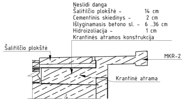
ŠALITILČIO PLOKŠTĖS ĮRENGIMAS ANT KRANTINĖS ATRAMOS NR. 1 (M 1:50)
