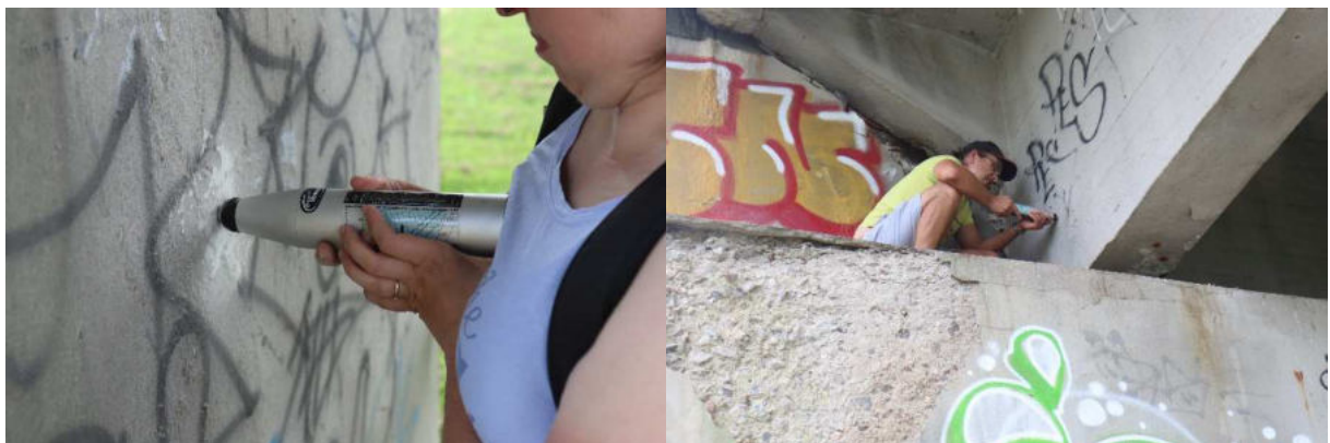
18 pav. Vidutinių cilindrinų betono stiprių matavimas Šmidto plaktuku.
