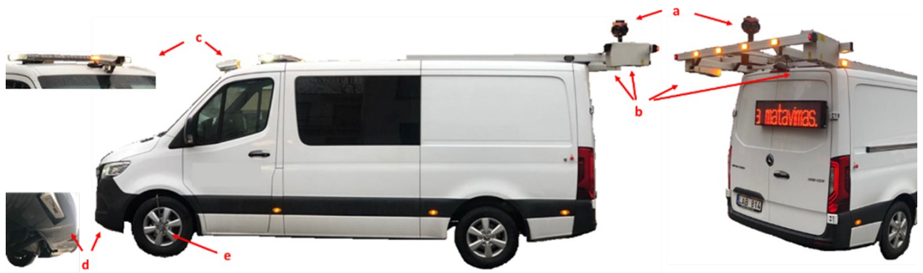
3 paveikslas. Mobilie kelių tyrimų įranga RST63 (a – 360 kamera; b – kelio paviršiaus skenavimo įranga LCMS-2; c – vaizdo fiksavimo įranga ir d – išilginio kelio profilio fiksavimo įranga)
