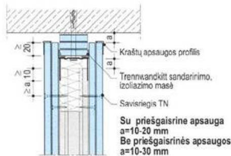
11 pav. Slankioji jungtis esant priešgaisriniams ir garso izoliacijos reikalavimams W112 – VO2
