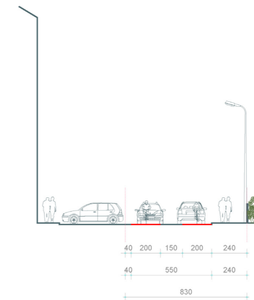
111 pav. Vingio g. tarp Melioratorių tako ir Butkų Juzės g. sprendimo rekomendacijų pjūvis. Schema mmap.
