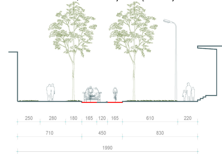
142 pav. Vasario 16-osios g. tarp Klaipėdos g. ir Gargždų „Minijos“ progimnazijos nebrangaus sprendimo rekomendacijų pjūvis. Schema mmap.
