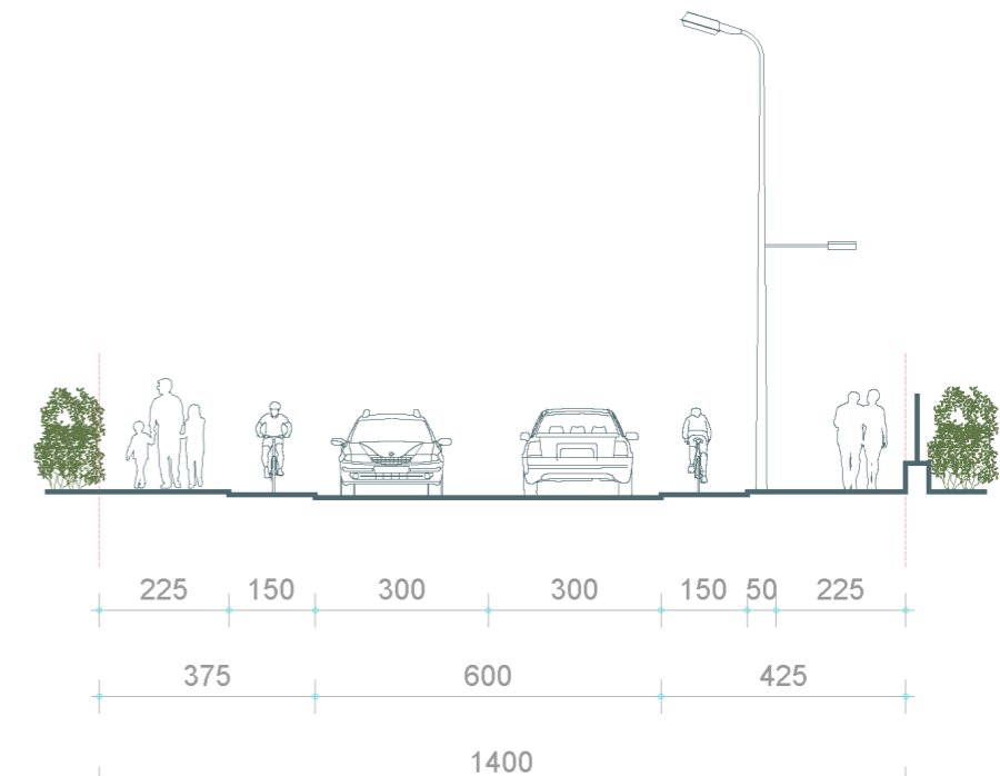
85 pav. J. Basanavičiaus g. tarp Klaipėdos g. ir Taikos g. sprendimo rekomendacijų pjūvis. Schema mmap.
