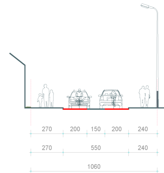
140 pav. Turgaus g. tarp Smėlio g. ir J. Basanavičiaus g. sprendimo rekomendacijų pjūvis. Schema mmap.
