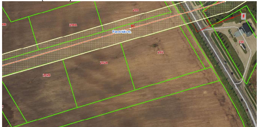
Pav. 1 110 kV elektros tinklų orinė linija palei šiaurinę nagrinėjamų sklypų ribą.
