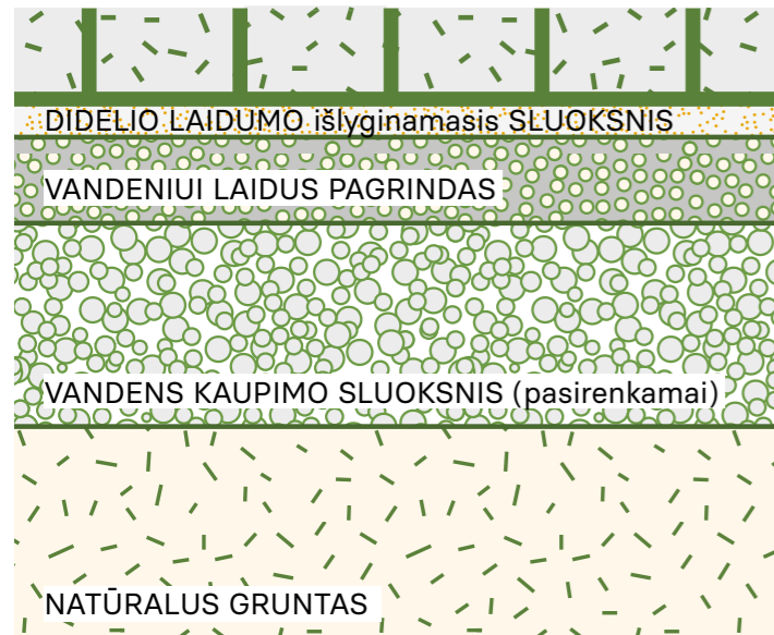
Plastikiniu koriu sutvirtintos vejės dangos konstrukcija
