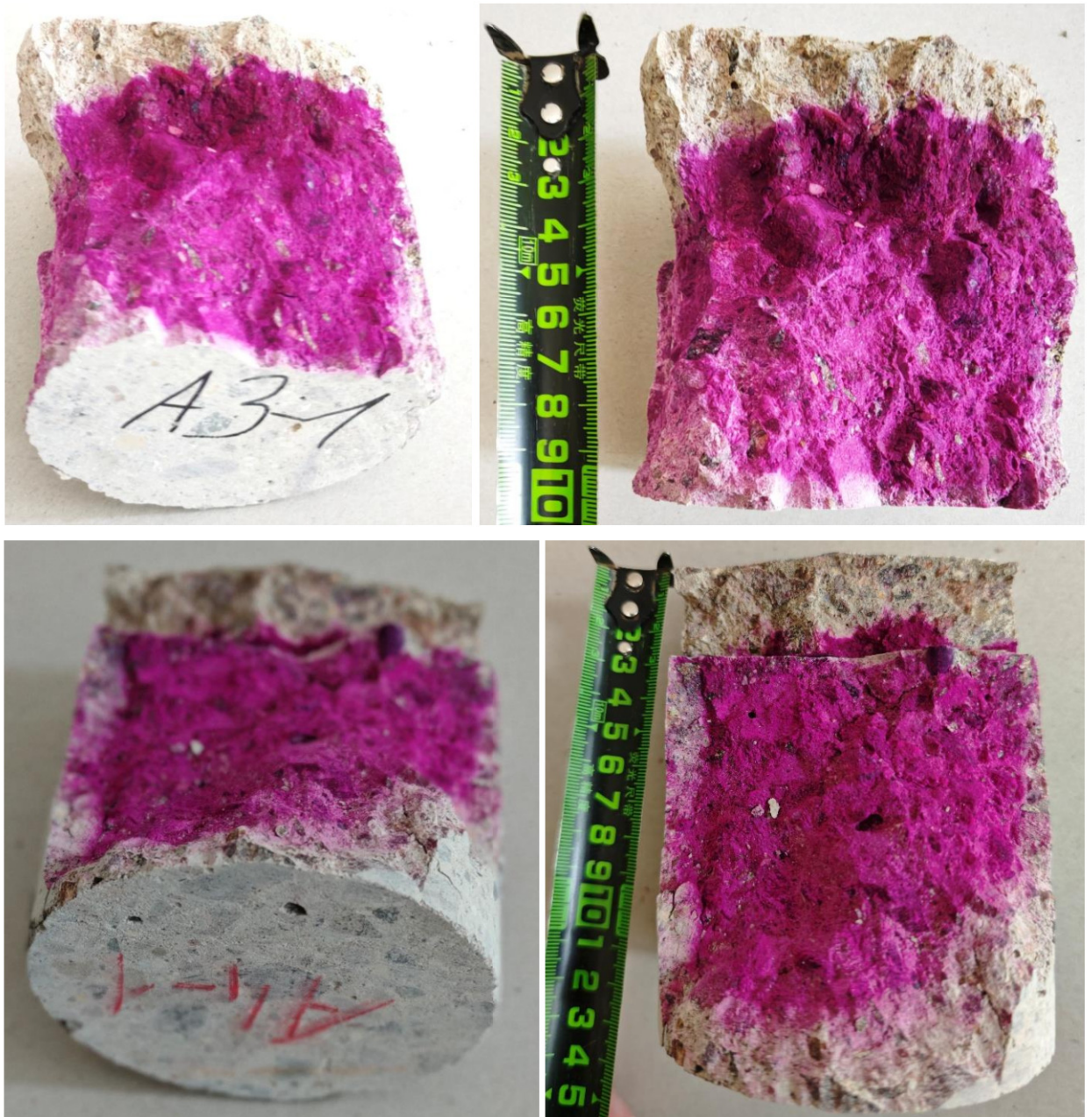
32 pav. Atramų 3 ir 4 betono ėminiuose A3-1 (viršuje) ir A4-1 (apačioje) pasireiškusi karbonizacija
