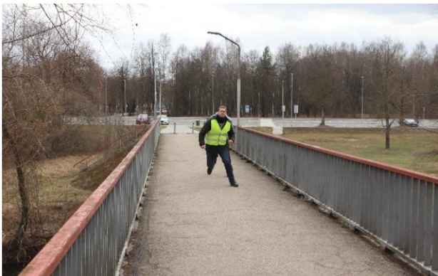
13 pav. Tilto perdangos žadinimas skirtingo pobūdžio ir intensyvumo išoriniais poveikiais
