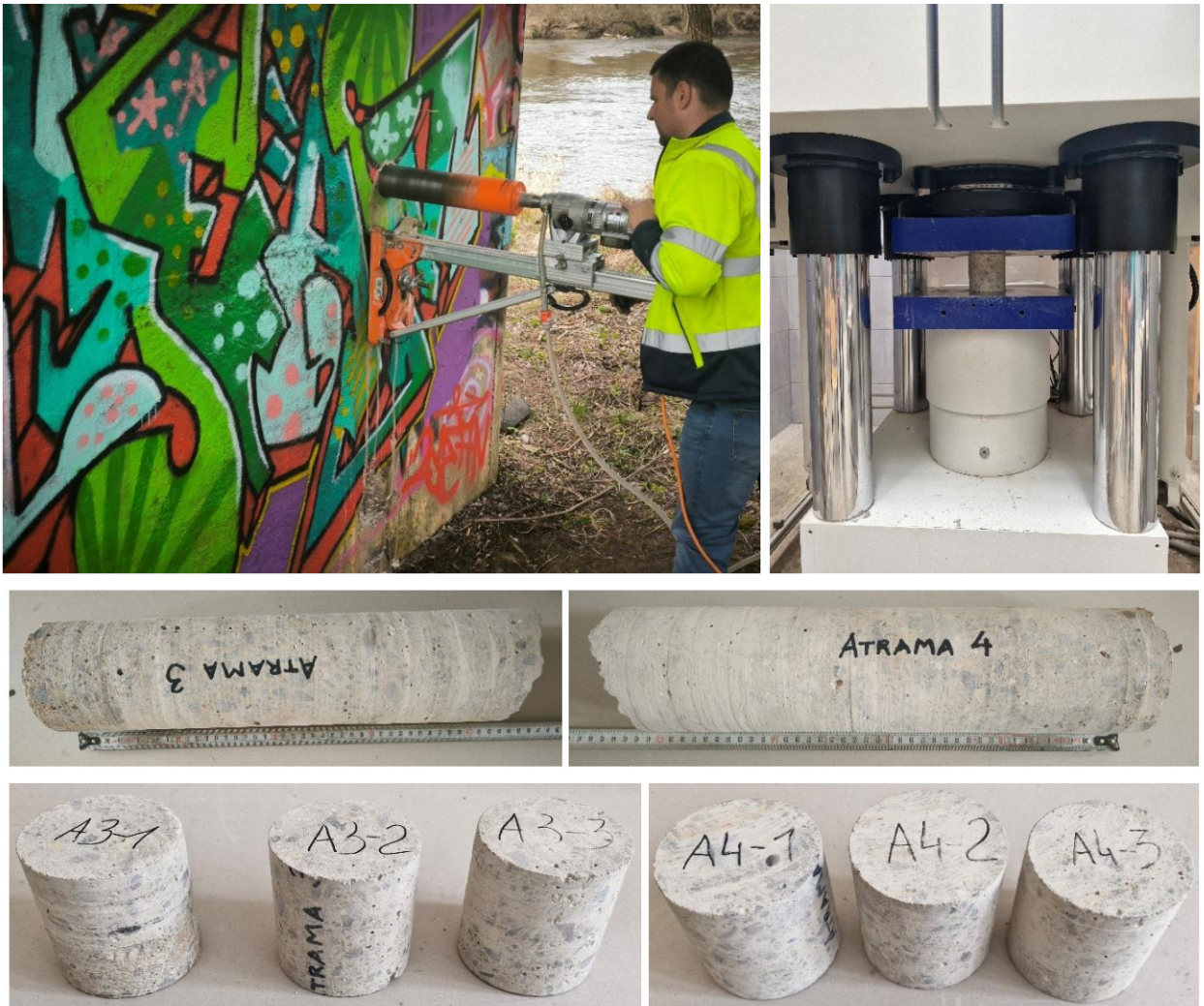
10 pav. Betono gniuždomojo stiprio nustatymas ardančiuoju būdu: kernų gręžimas (viršuje kairėje), suformuotų bandinių bandymas gniuždymo presu (viršuje dešinėje), išgręžtų kernų bendri vaizdai (viduryje), ardantiesiems bandymams suformuotų bandinių bendri vaizdai (apačioje)
