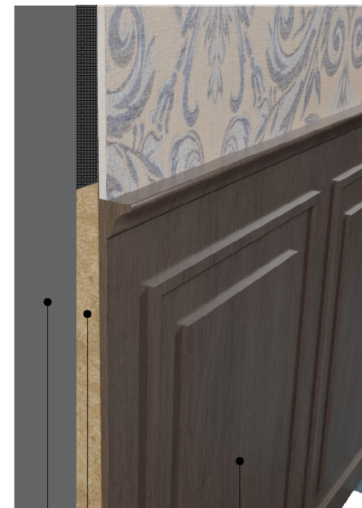
Esama pertvaros konstrukcija 50mm mineralinė vata klijuojama prie esamos konstrukcijos Fibro gipso pagrindo membraninė plokštė su natūralia faneruote ir nano perforacija
