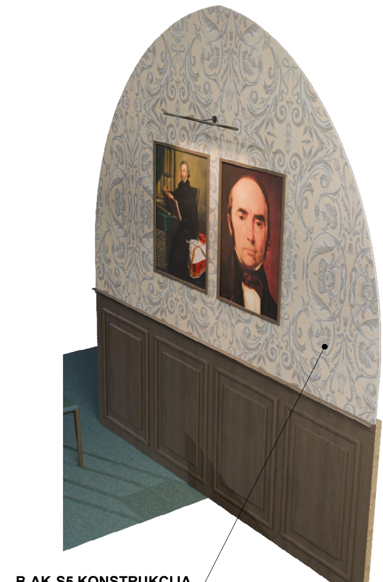
B-AK-S5 KONSTRUKCIJA membraninė plokštė su tekstiliniu tapetu
