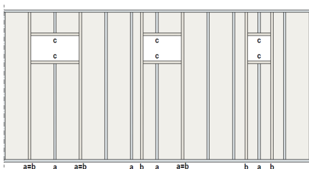
30 pav. Profilių išdėstymas ir įrengiant angas pertvarose. Pagrindinis statramstis (a): pertvaros vertikalus statramstis išdėstytas leistinu atstumu per visą patalpos aukštį. Keičiamas statramstis (b): vertikalus, papildomas profilis per visą patalpos aukštį. Pagrindinis statramstis gali būti naudojamas kaip keičiamas statramstis, jeigu anga tiesiogiai ribojasi su pagrindiniu statramsčiu. Keičiamas profilis (c): horizontalus papildomas profilis, skirtas angos aprėminimui tarp keičiamų statramsčių.
