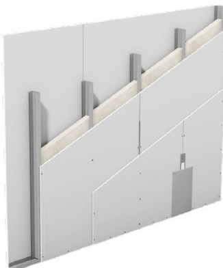
17 pav. Metalinio karkaso pertvara su dviejų gipskartonio sluoksnių apkala
