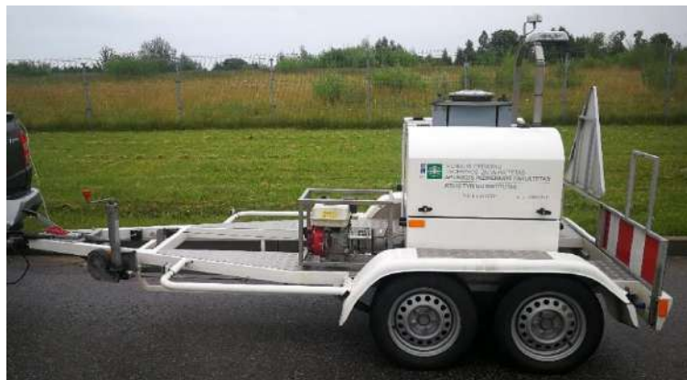
5.1 pav. Krintančio svorio deflektometras „PRIMAX 2500“
