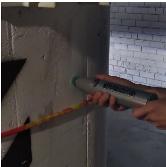
1.10 pav. Neardantys betono tyrimai
