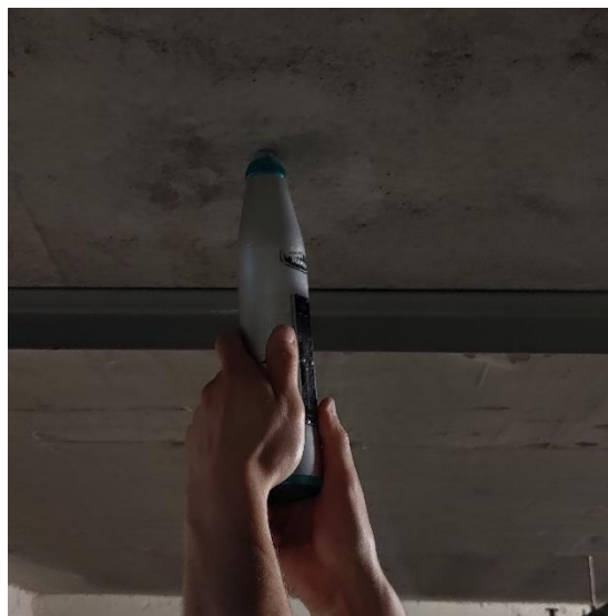
1.10 pav. Neardantys betono tyrimai
