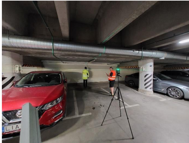
2.37 pav. Korpusas B. Įlinkių matavimas
