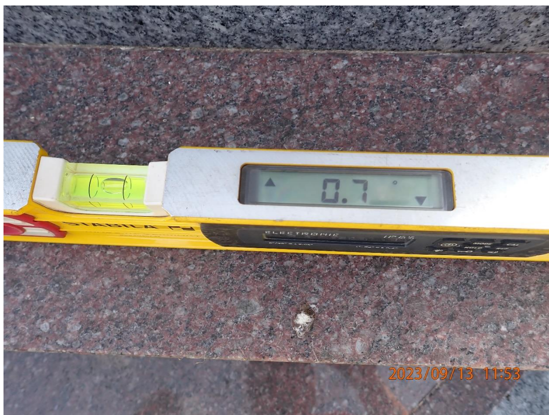
Nuotrauka Nr. 6. Paminklo horizontalaus paviršiaus posvyrio matavimas
