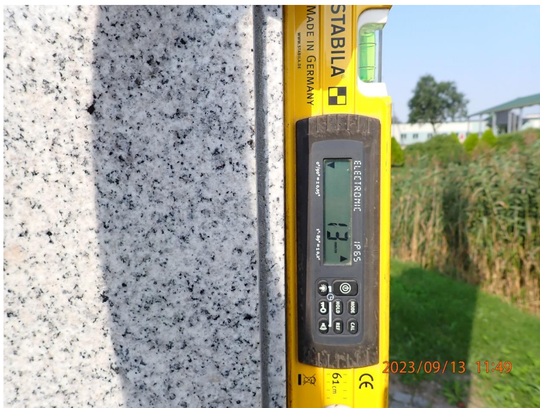
Nuotrauka Nr. 5. Paminklo vertikalaus paviršiaus posvyrio matavimas
