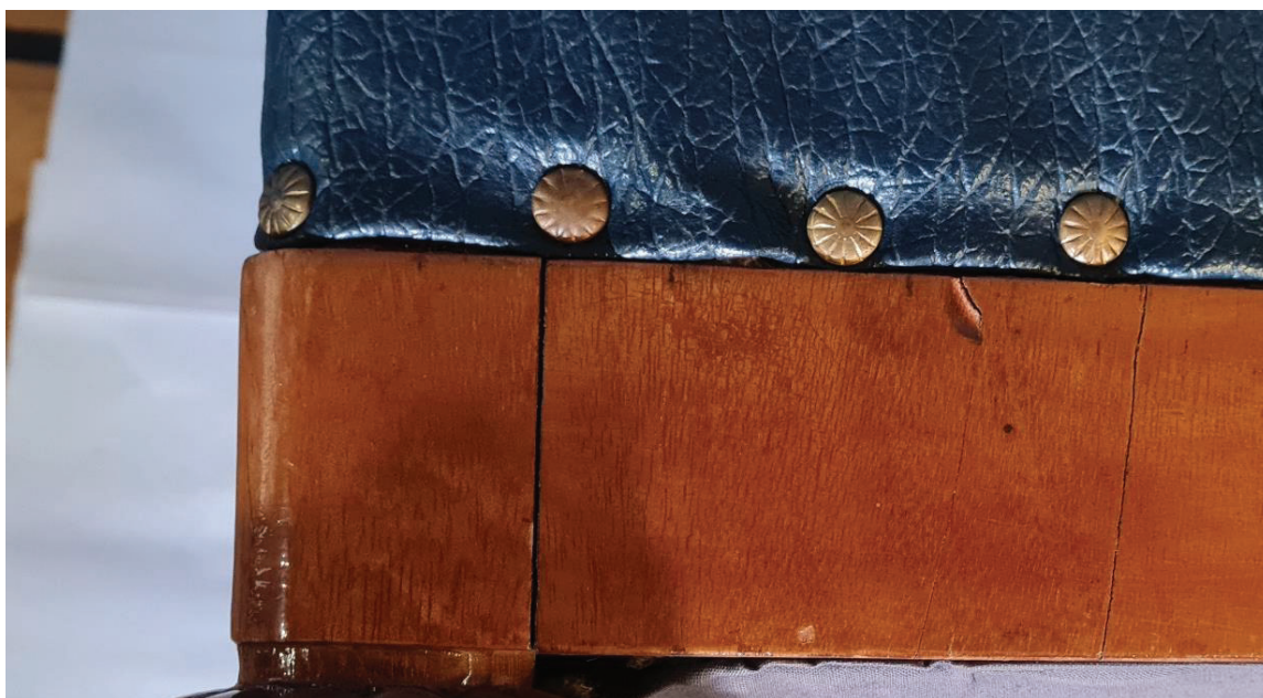
29 foto. Vaizdinės pusės priekinio kojaryšio rėmo defektų vaizdas
