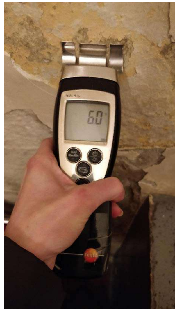
Nuotrauka Nr. 59. Zakristijos sienų prie įėjimo drėgmės rodmenys. Drėgmė nežymiai viršija normą.
