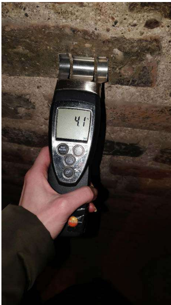
Nuotrauka Nr. 58. Pietinio bokšto mūro drėgmės rodikliai. Drėgmė normos ribose.
