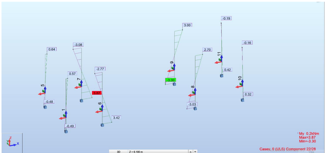
pav. 16 Veikiantys lenkimo momentai M_y nuo ULS/22 apkrovų derinio
