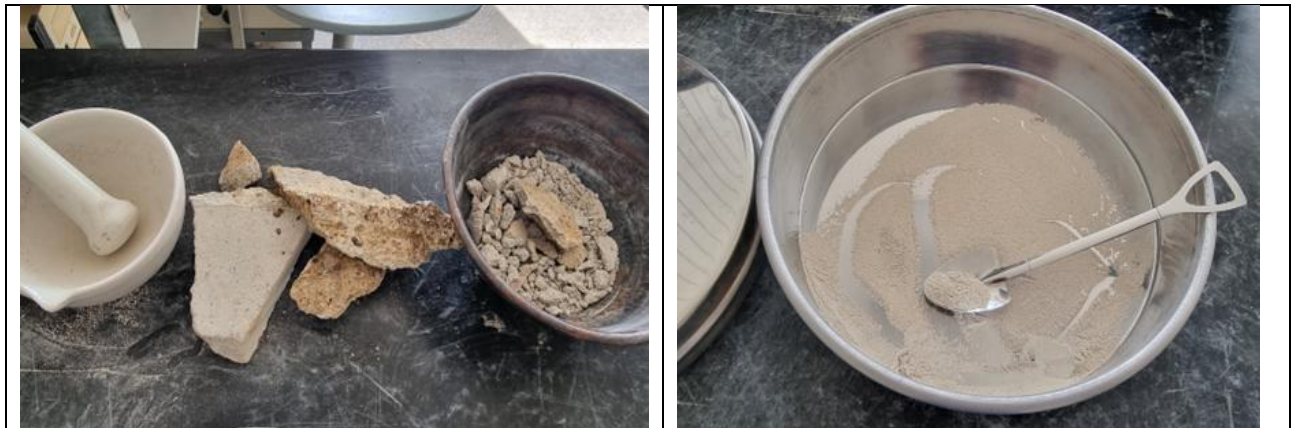
4 pav. XRD ir EDS tyrimams paruošti betono fragmentų milteliai
