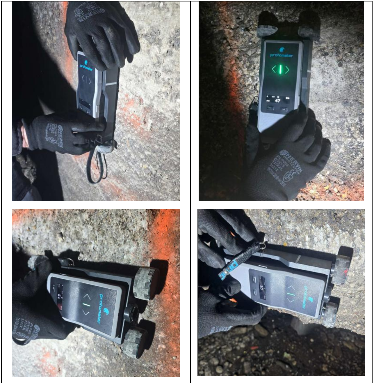
Pav. 6.2 armatūros ir jos apsauginio betono sluoksnio storio nustatymas
