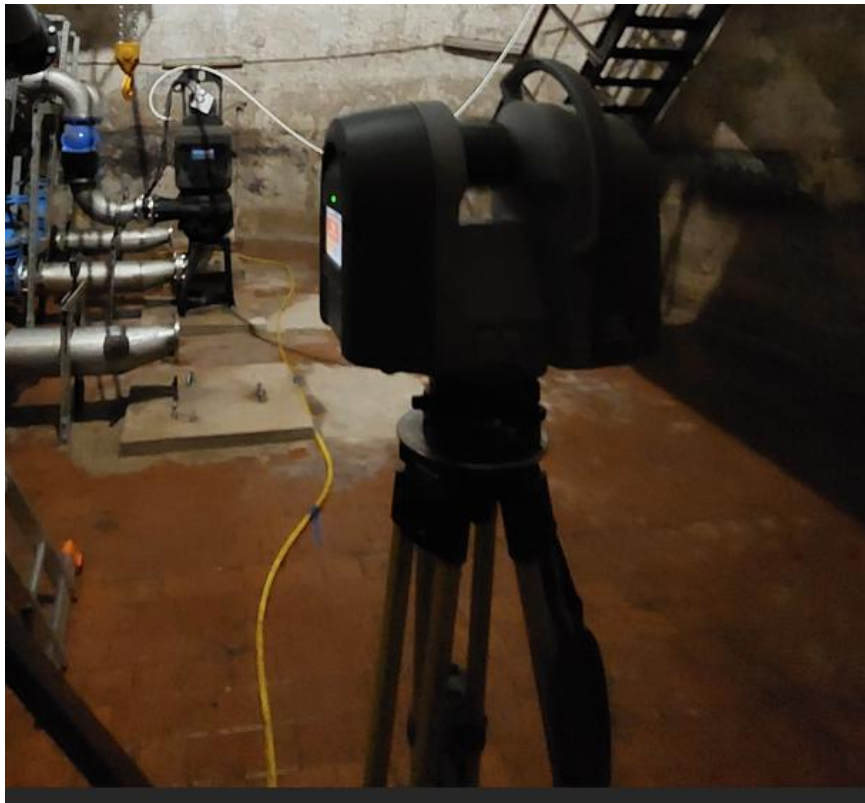
Pav. 6.12 Statinio konstrukcijų skenavimas 3D
