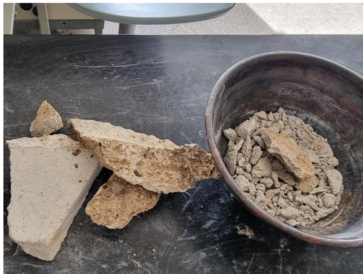
1 pav. Betonų cheminės struktūros analizei įvertinti pristatyti betoniniai fragmentai
