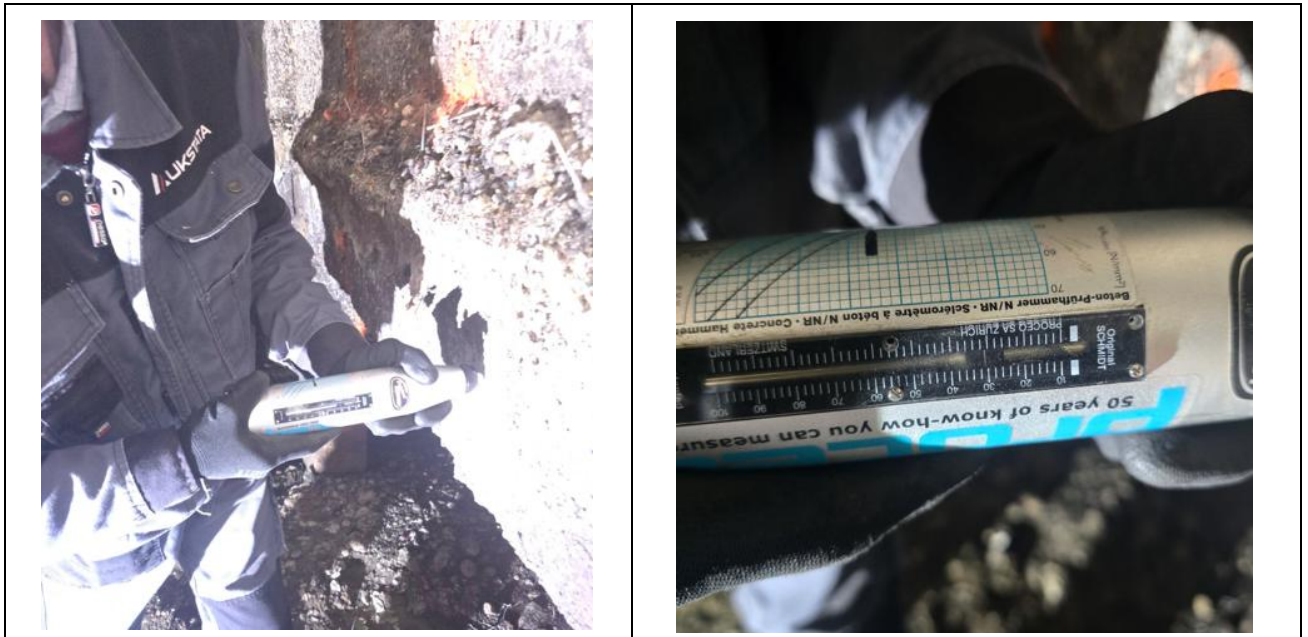
Pav. 6.9 betono stiprio testas Šmidto plaktuku
