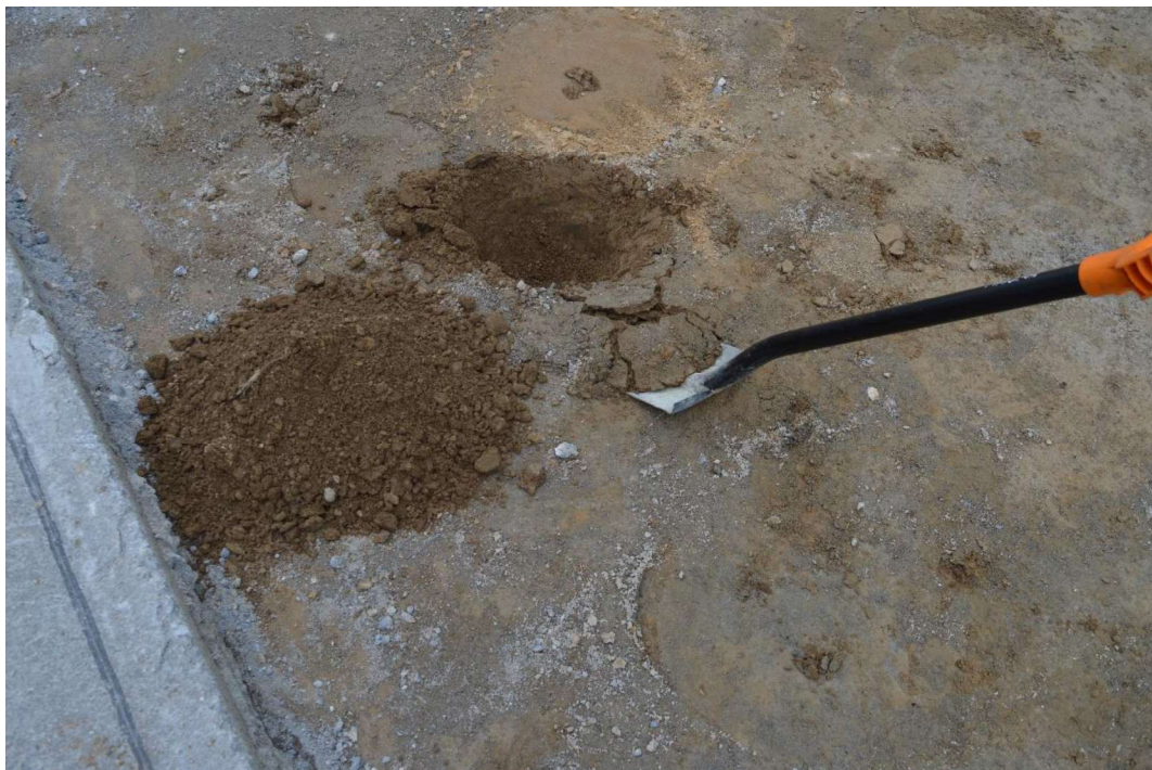
Stabilizuotas sluoksnis birus, laisvai kasamas kastuvu. Bandant išgręžti kerną bandinys subyra.
