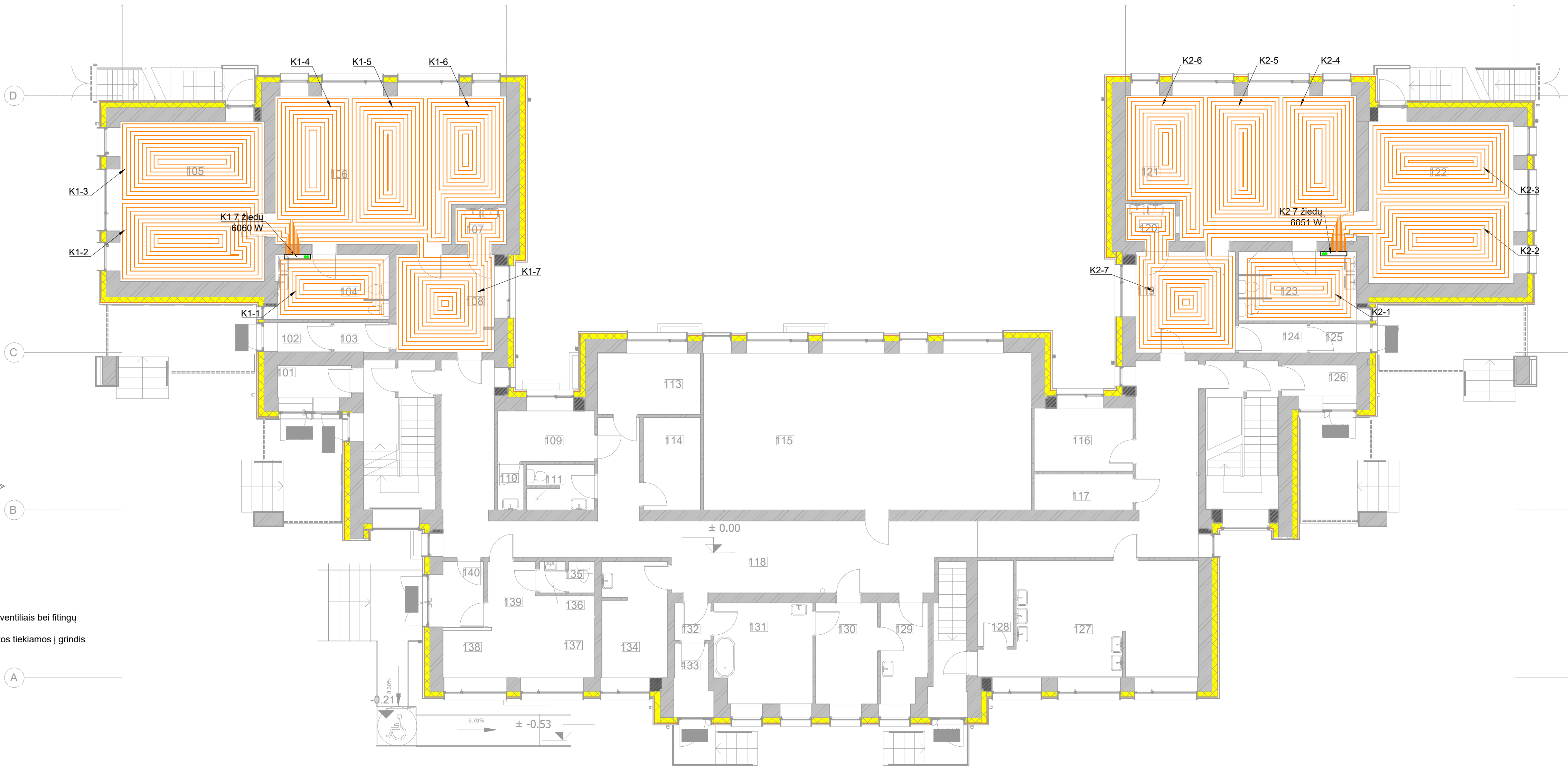
Pirmo aukšto planas su grindinio šildymo sistemomis M1:100
