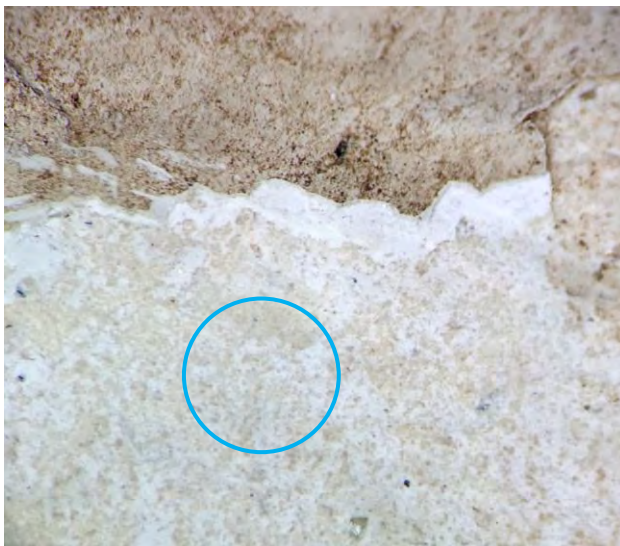
2 pav. c) Mėginys Nr.2 – T2 (interjero dekoratyvinis tinkas. Tarnybinė laiptinė II a.). Vaizdas pro mikroskopą, x15. Matomi marmuro grūdėliai (dulkės)
