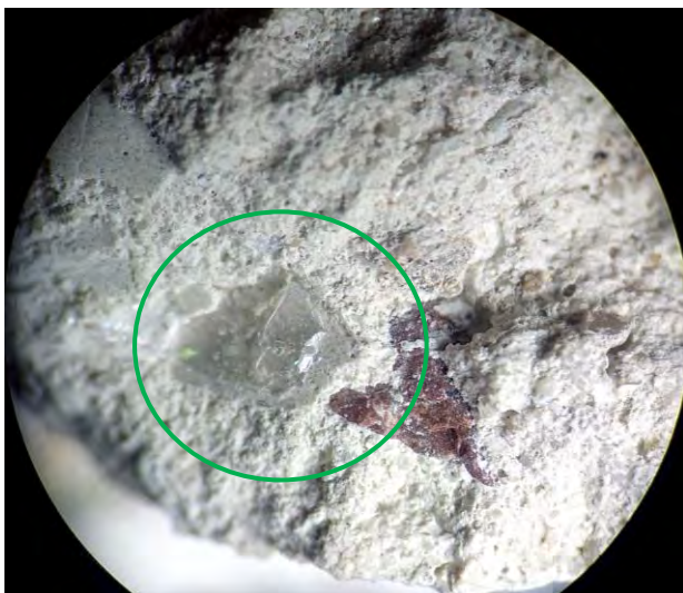
2 pav. e) Mėginys Nr.2 – T2 (interjero dekoratyvinis tinkas. Tarnybinė laiptinė II a.). Vaizdas pro mikroskopą, x20. Matomos žėručio plokštelės
