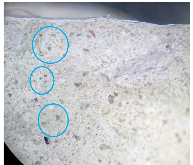
2 pav. d) Mėginys Nr.2 – T2 (interjero dekoratyvinis tinkas. Tarnybinė laiptinė II a.). Vaizdas pro mikroskopą, x20. Matomi marmuro grūdėliai (dulkės)
