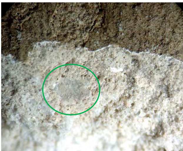
1 pav. c) Mėginys Nr.1 – T1 (eksterjero dekoratyvinio tinko, galerijos sienutė). Vaizdas pro mikroskopą, x15. Matomos žėručio plokštelės
