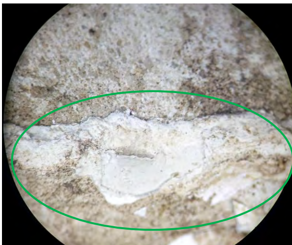
1 pav. f) Mėginys Nr.1 – T1 (eksterjero dekoratyvinio tinko, galerijos sienutė). Vaizdas pro mikroskopą, x20. Matomas dar vienas plonas dekoratyvinio tinko sluoksnelis
