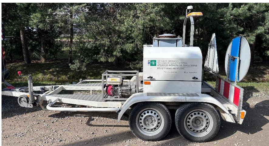
5.1 pav. Krintančio svorio deflektometras „PRIMAX 2500“
