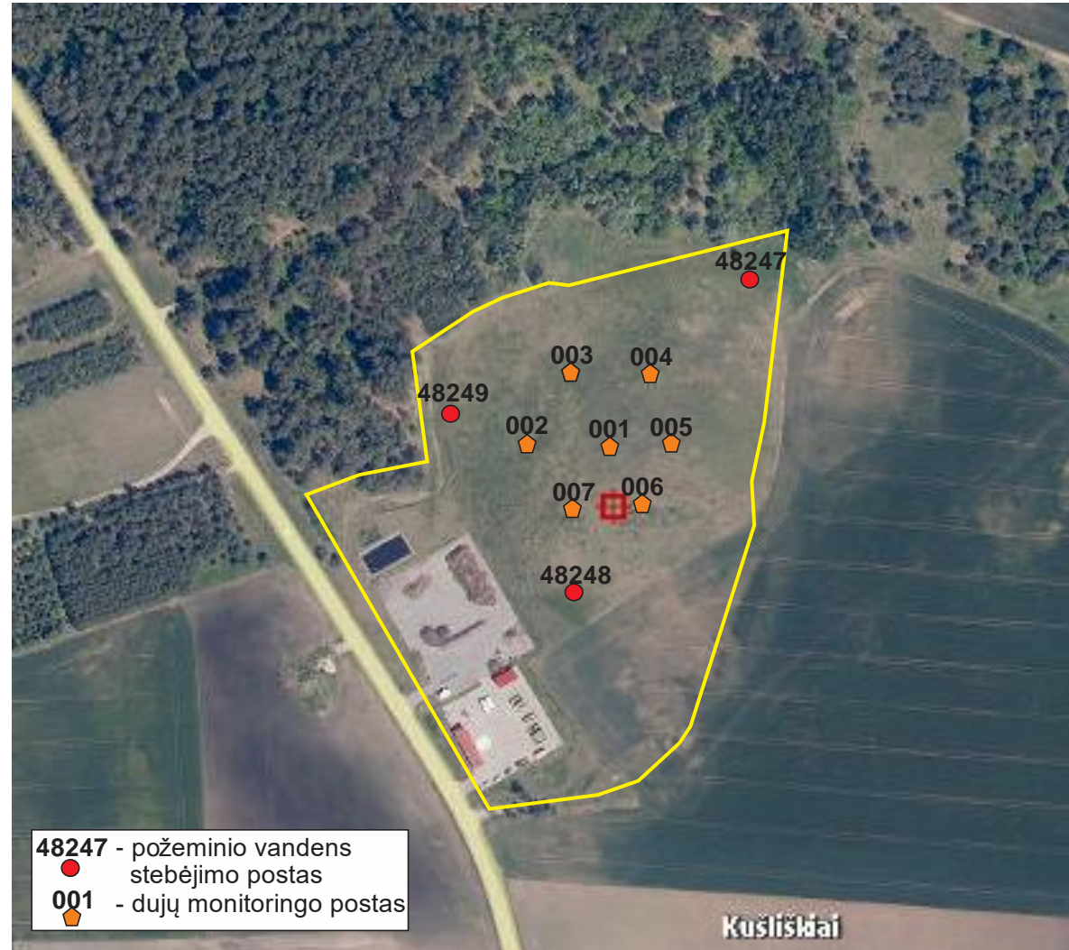
7.1 pav. Uždaryto sąvartyno schema su požeminio vandens ir dujų stebėjimo postais. M 1:5000.
