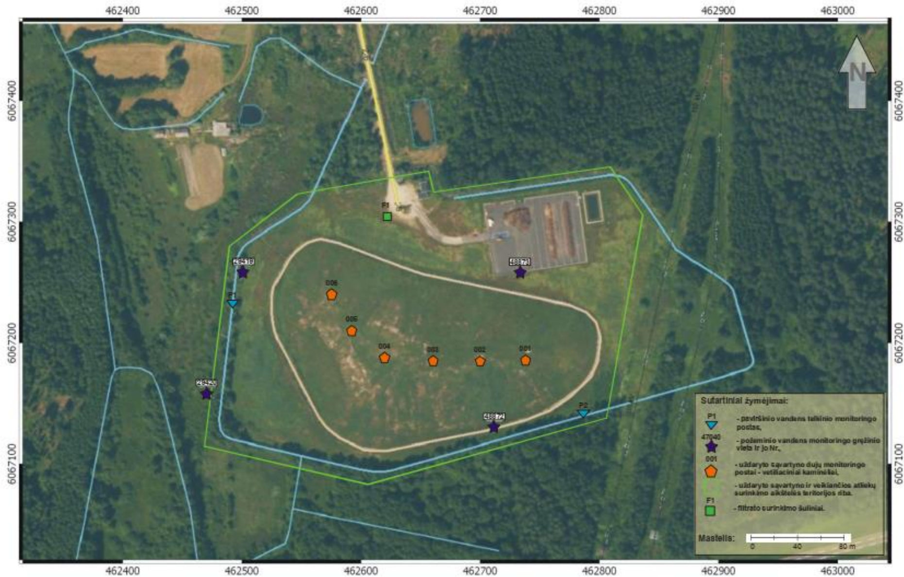
7.1 pav. Kazlų Rūdos sąvartyno schema su stebimųjų gręžinių vietomis, dujų monitoringo bei paviršinio ir drenažinio vandens stebėjimo postais (8).
