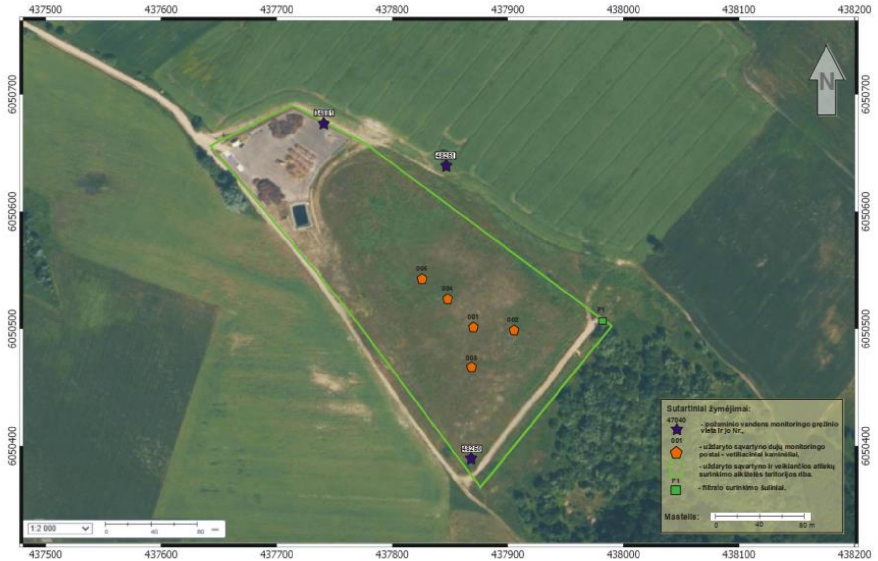
7.1 pav. Vilkaiviškio sąvartyno schema su stebimųjų gręžinių vietomis, dujų monitoringo bei drenažinio vandens stebėjimo postais (8).
