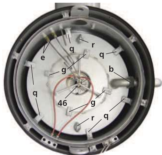
Dampfautomat mit Ölfeuerung ohne Zwischendeckel Steam generator with oil firing without intermediate cover
