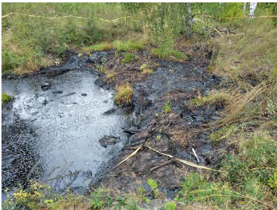
4 pav. Užterštas gruntas iškasoje ties naftos produktų sankaupa ekogeologinio tyrimo metu (2024-08-12)
