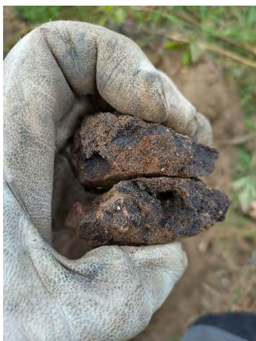
3 pav. Grunto ir mazuto homogenizuoti dariniai. Kairėje pusėje atskelti mazuto ir grunto pavyzdžiai. Dešinėje pusėje nuotrauka iškasos viduje (2024-08-12)
