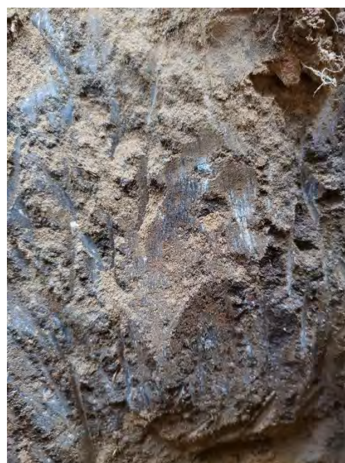
3 pav. Grunto ir mazuto homogenizuoti dariniai. Kairėje pusėje atskelti mazuto ir grunto pavyzdžiai. Dešinėje pusėje nuotrauka iškasos viduje (2024-08-12)
