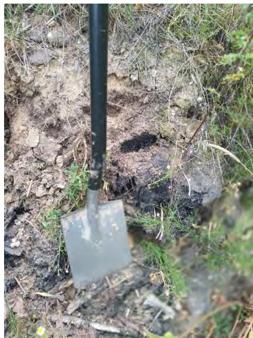
5 pav. Kairėje – užterštas gruntas iškasoje ties naftos produktų sankaupa. Dešinėje – naftos produktais užterštas gruntas ties šiaurės vakarine iškasos riba (2024-08-12)
