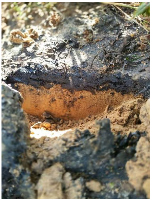
5 pav. Kairėje – užterštas gruntas iškasoje ties naftos produktų sankaupa. Dešinėje – naftos produktais užterštas gruntas ties šiaurės vakarine iškasos riba (2024-08-12)
