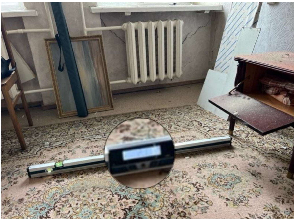
43 pav. Fiksuotas grindų įdubimas, 2.1%. Deformacija po langu
