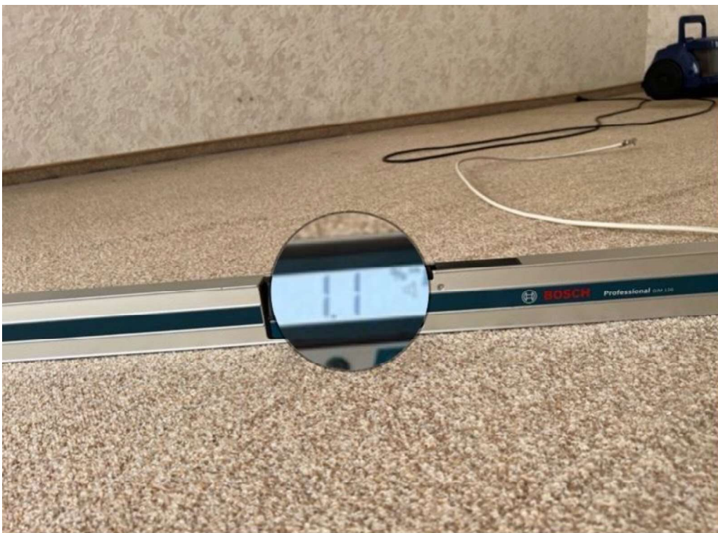
39 pav. Fiksuotas grindų įdubimas, 1.1%
