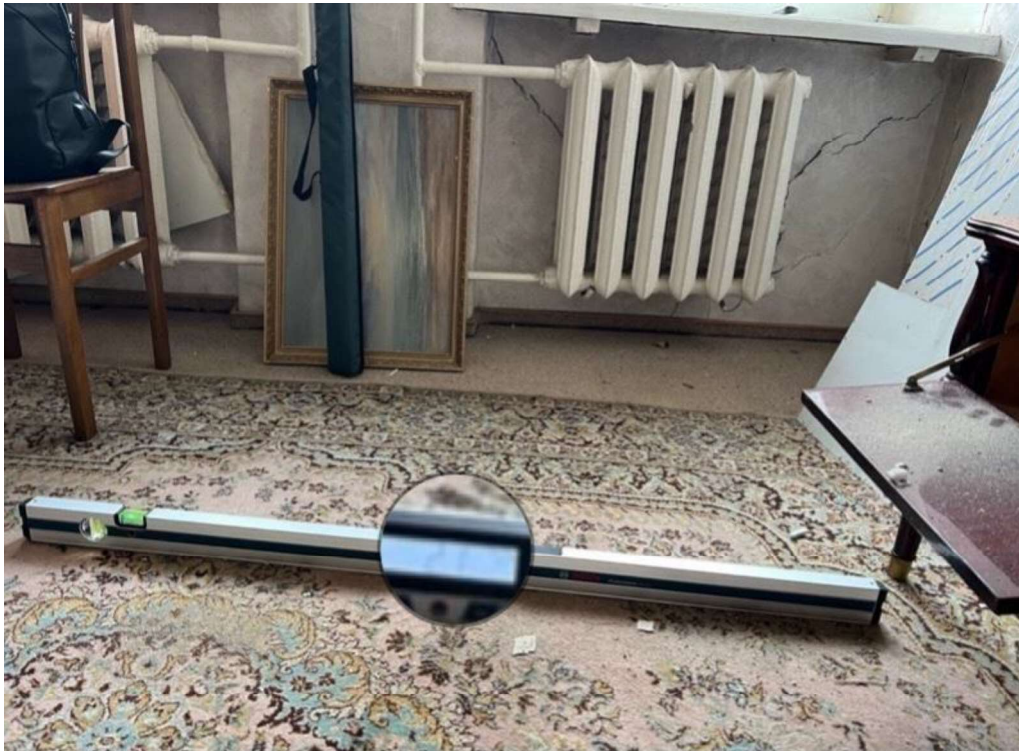
44 pav. Fiksuotas grindų įdubimas, 2.1%. Deformacija po langu
