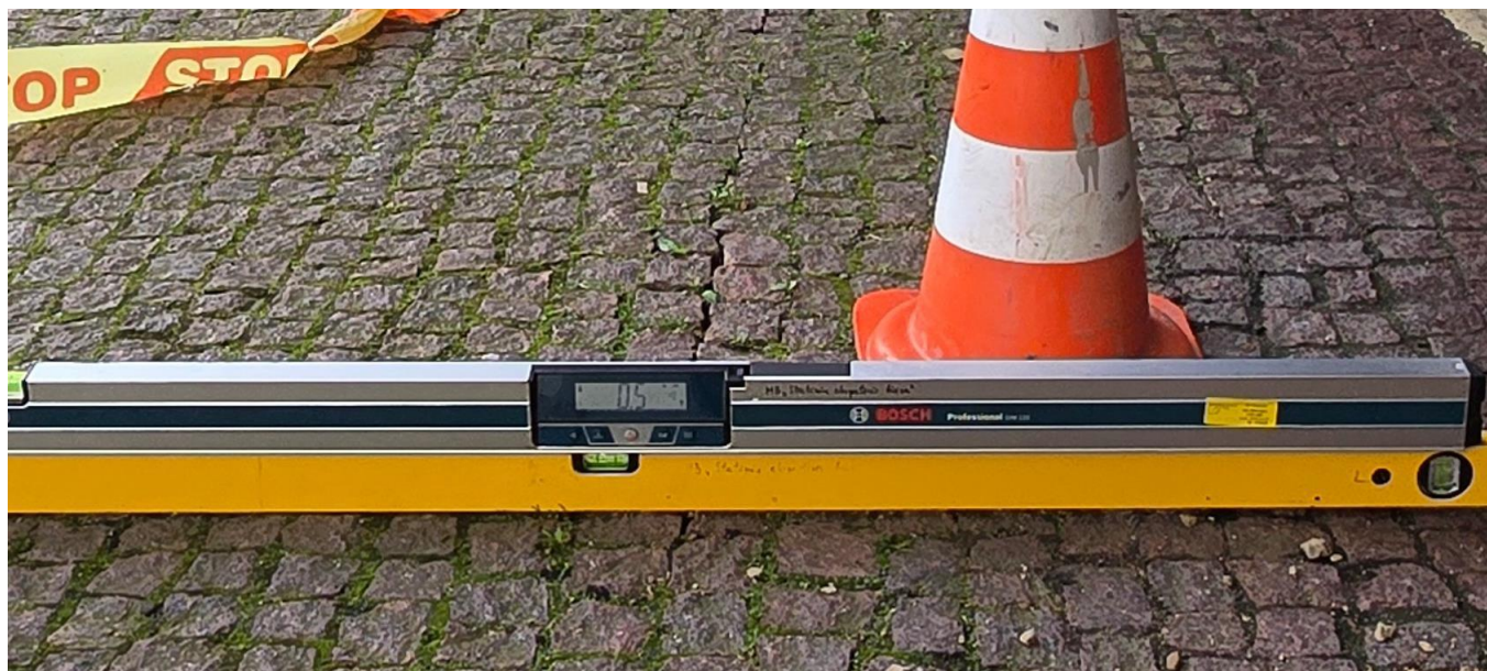
Nuotrauka Nr. 21 Eksploatuojamo stogo nuolydis nepakankamas, tik 0,5^\circ , kai turėtų būti ne mažesnis kaip 0,7^\circ ir ne didesnis kaip 7^\circ .
