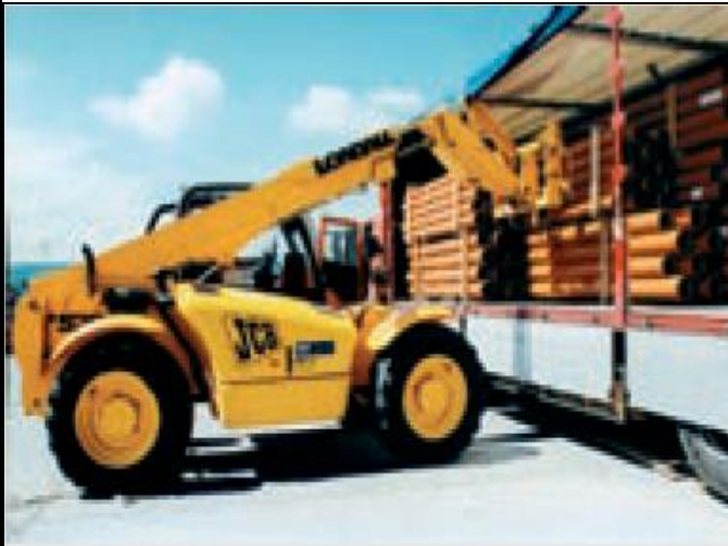
2 pav. Mechanizuotas vamzdžių krovimas
